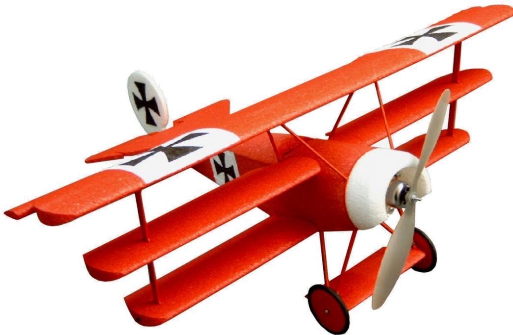
Semi-Scale Motorflugmodell aus voll durchgefärbtem EPP (Expanded Poly Propylen) für Brushless Elektromotoren der 400-er Klasse und mindestens 4-Kanal Funkfernsteuerung.
