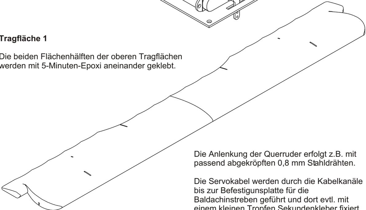
Die Anlenkung der Querruder erfolgt z.B. mit passend abgekröpften 0,8 mm Stahldrähten.
